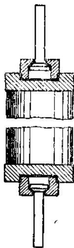
Рис. 4. Схема металлического приспособления для прямого растяжения бетонных кернов.
