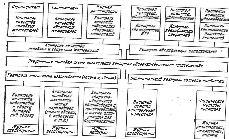
Рис. 2.10. Схема организации контроля качества сварных конструкций и оборудования при их укрупнении и монтаже
