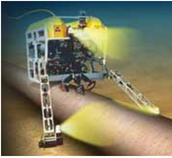
Рис. 2. ТНПА «Пантера Плюс» с комплексом обследования трубопроводов
