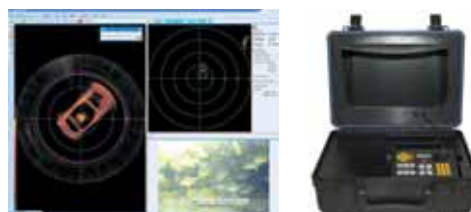
Планшет с программными окнами гидролокатора, системы позиционирования и видео с камеры
