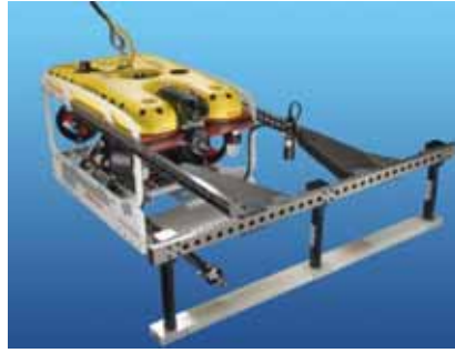
Рис. 3. ТНПА «Фалкон» с трассоискателем и профилемерами
