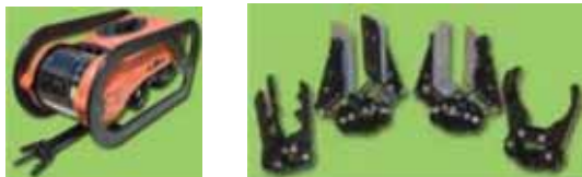
Манипулятор со сменными схватами
