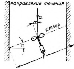
Рис. 98. Направление течения под острым углом к оси вертушки. Угол \alpha .
