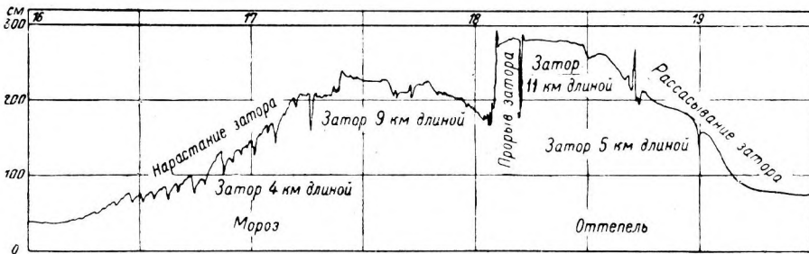
Рис. 297. График колебания уровня воды р. Инн у Вернштейна во время затора льда в январе 1905 г.
