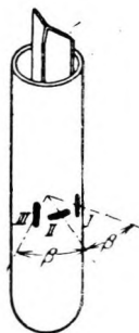
Рис. 137. Цилиндрическая напорная трубка, чувствительная к изменениям направления течения, системы Гутче.
