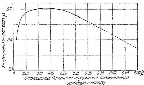
Фиг. 20. График изменения коэффициента расхода в зависимости от отношения открытия затвора к напору для сегментных затворов головного сооружения плотины.
